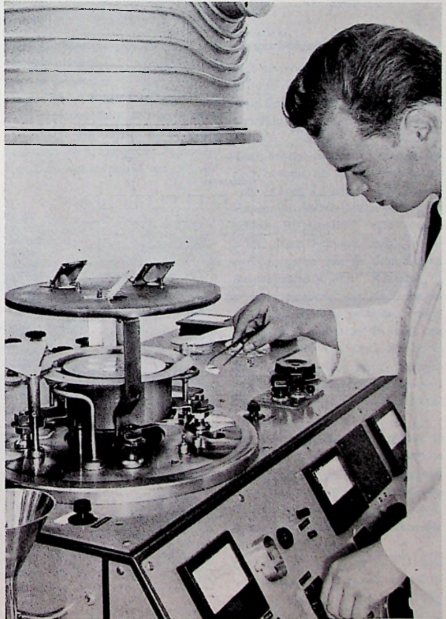
Apparatuur voor het opbrengen van de resistlaag op het siliciumplaatje.
