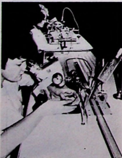
Figuur 1 toont een gedeelte van de epoxy encapsulated transistor productielijn. Op de voorgrond is een automatische alloying machine en op de achtergrond wordt een automatische bonding machine getoond.
